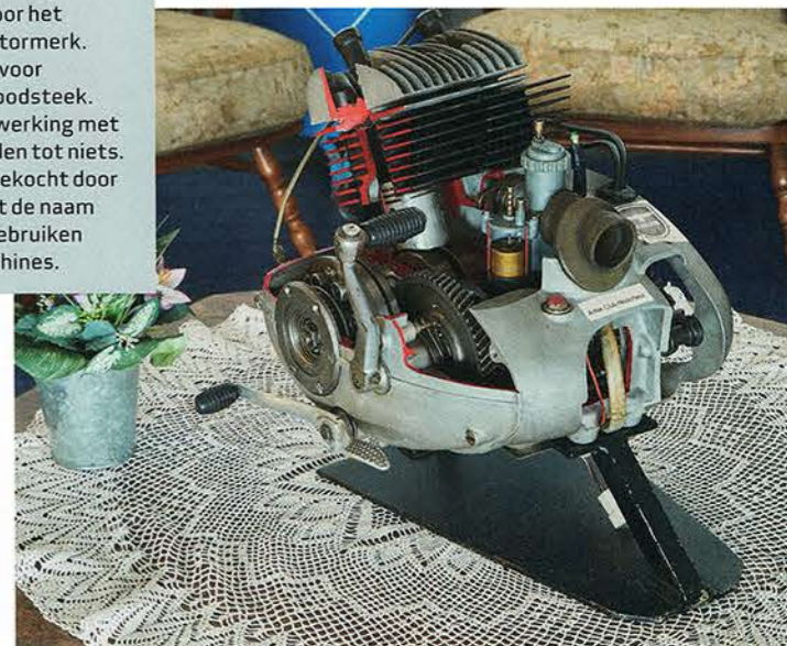
Het 'leermodel' van de MB250. Ooit bedoeld voor de instructie aan de monteurs in opleiding.
